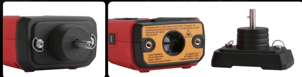
UT372D 2-in-1 타코미터는 접촉식 및 비접촉식 측정이 가능한 안정적인 타코미터입니다. 주로 모터, 팬, 자동차, 제지 등의 분야에서 RPM(Revolutions Per Minute), 주파수, 표면 속도 및 길이를 측정하는데 사용됩니다.
